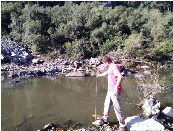
Figura 8 - Coleta de amostra para análise de sólidos em suspensão com o amostrador DH-48. Fonte: Ecossis, 2021.
