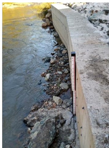
Figura 1 - Novas réguas instaladas no Arroio Candiota Jusante
