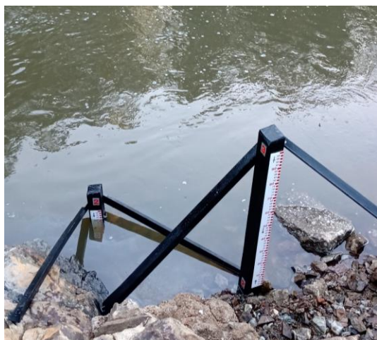
Figura 1 - Novas réguas instaladas no Arroio Candiota Jusante
